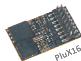
MX648P16 NEM 658 directly on decoder
